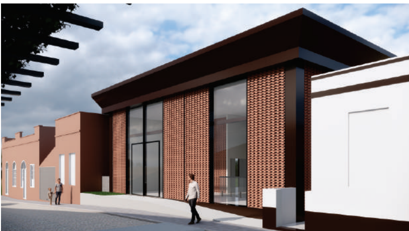
Imagens mostrando a aplicação do tijolo maciço na fachada e acabamento da platibanda com o elemento em fibra de vidro pintado.
